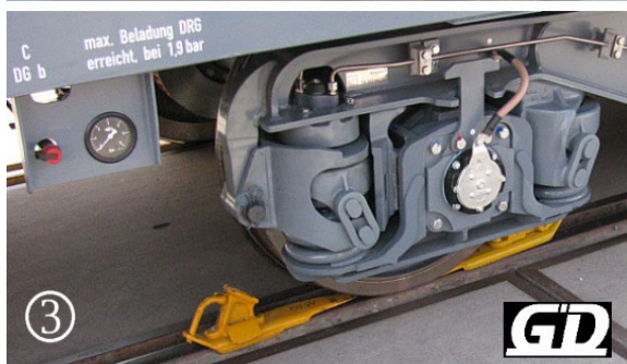
Drehgestell ELH Y25SWM gesehen auf dem Freigelände unter U-Bahn Arbeitswagen 9953 SWM (Stadtwerke München) Bogie ELH Y25SWM seen at outdoor display with subway maintenance car 9953 SWM (Stadtwerke München)
