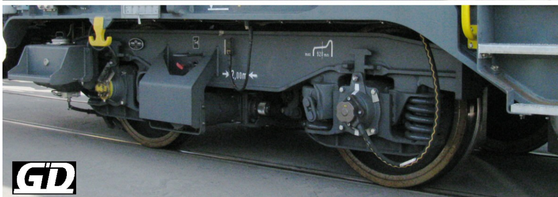
Drehgestelle für Erhaltungsfahrzeug ELH Y33Lsi-Fsp-265 kW mit wassermantelgekühltem Motor und zweistufigem Getriebe; verwendet unter Xem 99 85 9181 013-5 CH -SBB I "Biasca" Bogies for Maintenance Rail Car ELH Y33Lsi-Fsp-265 kW with water cooled motor and 2-stages gear box, used with Xem 99 85 9181 013-5 CH -SBB I "Biasca"
