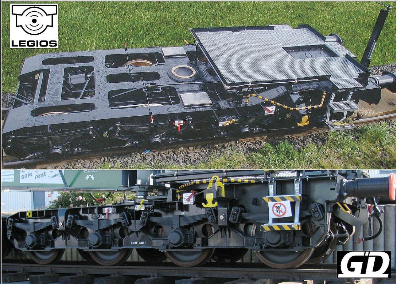
Schwerlast-Drehgestell Legios TSW 348 (End-Drehgestell), gesehen auf dem Freigelände unter neuem Kübler-Tragschnabelwagen "33 54 9946 002-7" Uaai
