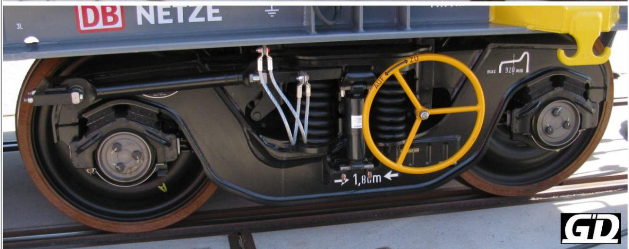
Güterwagen-Drehgestell ELH RC25NT-C(f)h, gesehen auf dem Freigelände unter MTF 40 (Aussteller Tatravagónka Poprad) 99 80 D-DB 9370 038-8, DB Netz Notfalltechnik
