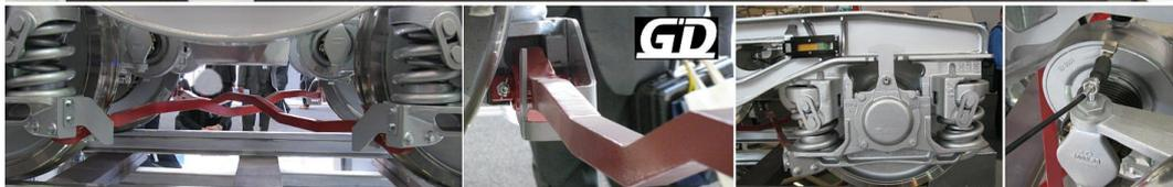
Güterwagen-Drehgestell TVP NG-DBS (mit Kreuzanker-Kopplung und Bremsbelagverschleißanzeige)
