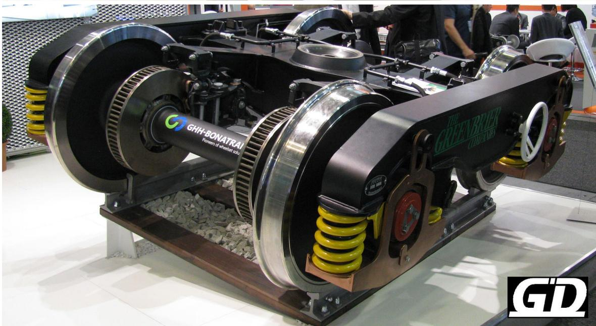
Güterwagen-Drehgestell Greenbrier GB25RS (mit Scheibenbremsen und bodenbedienbarer Feststellbremse)
