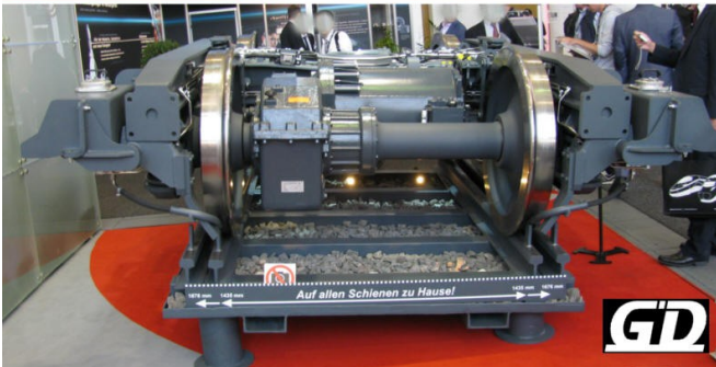
Drehgestell für Erhaltungsfahrzeug ELH Y33Lsi-Fsp-265 kW mit wassermantelgekühltem Motor und zweistufigem Getriebe Bogie for Maintenance Rail Car ELH Y33Lsi-Fsp-265 kW with water cooled motor and 2-stages gear box.
