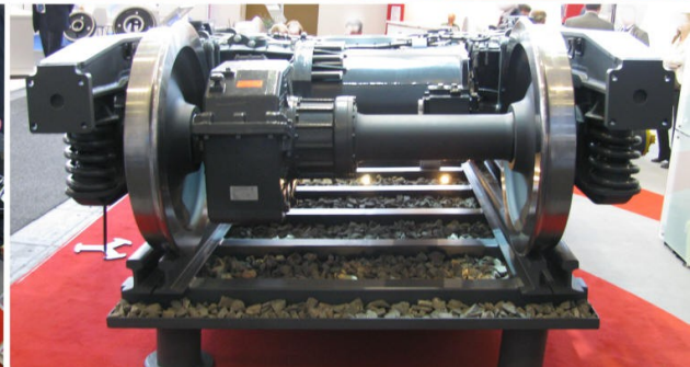
Drehgestell für Erhaltungsfahrzeug ELH Y33Lsi-Fsp-265 kW mit wassermantelgekühltem Motor und zweistufigem Getriebe Bogie for Maintenance Rail Car ELH Y33Lsi-Fsp-265 kW with water cooled motor and 2-stages gear box.
